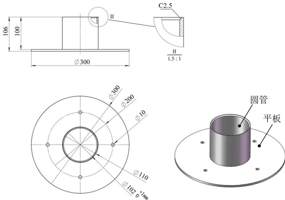
图3 球座（圆管内径 102mm）
