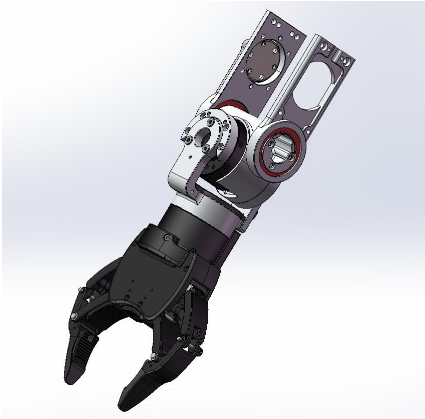
图 5 夹爪版末端机械安装效果示意图
