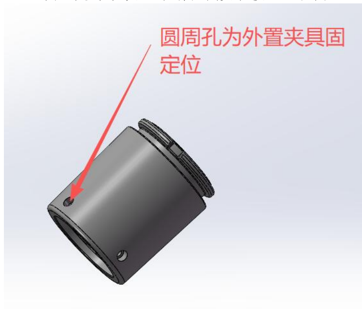
图 1 灵巧手/夹爪末端机械安装接口工程图
