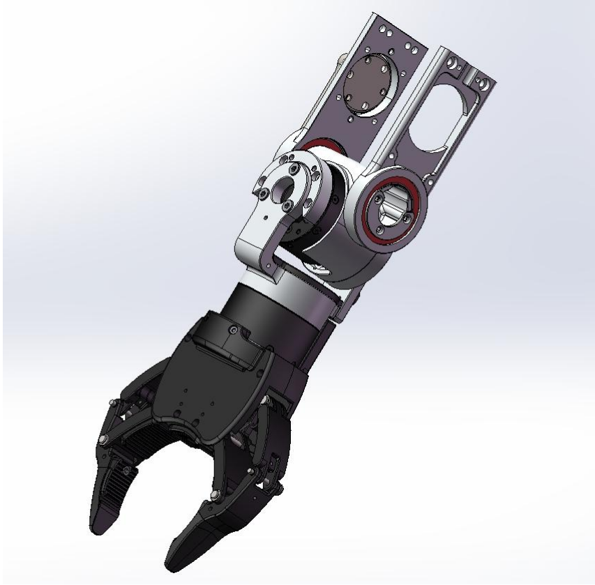
图 5 夹爪版末端机械安装效果示意图
